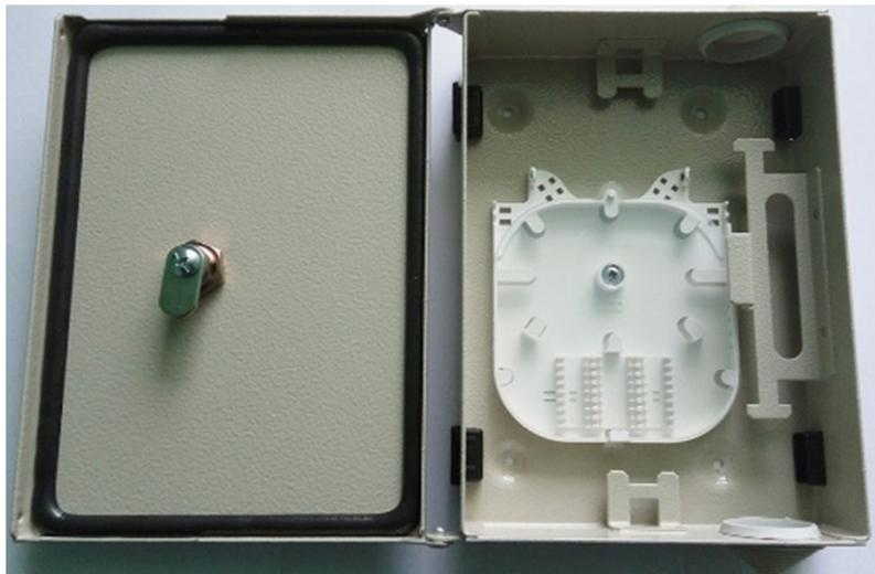
Предназначены для установки на этажных площадках в точках разветвления пассивных оптических сетей и подключения кабеля ОК-RISER абонентской разводки к распределительному участку с применением сварных соединений или механических соединителей. Конструкция кросса предусматривает возможность ввода в коробку трубы диаметром до 32 мм включительно и кабель-канала 11x22 мм для прокладки кабеля.
