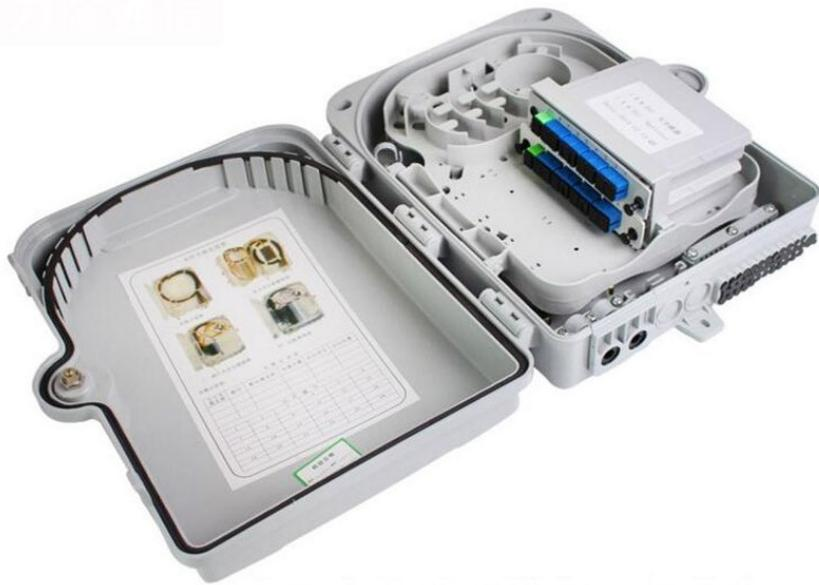
Предназначены для строительства в городских 2-3 этажных домах сетей PON с каскадным сплиттированием по схемам 1x16:1x4 или 1x8:1x8. Используются для фиксации кабеля, сварки волокон кабеля с пигтейлами, защиты места ответвления и сростков волокон, установки сплиттерных модулей и подключения абонентских кабелей. Оптоволоконный кабель крепится специальными прижимами, а для закрепления силовых элементов кабеля бокс комплектуется дополнительными фиксаторами.
