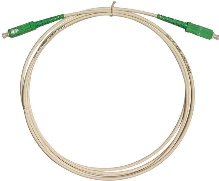
Предназначены для использования в сетях FTTH в условиях, подразумевающих изгибы малого радиуса. В кабелях используется одномодовое волокно стандарта G.657A, допускающее многократные изгибы с радиусом 15 мм. Представляет из себя негорючий одноволоконный LSZH кабель оконцованный разъемами, с наружным диаметром 2,0 мм. Для увеличения механических характеристик в структуре кабеля предусмотрены усиливающие арамидные нити под оболочкой.
