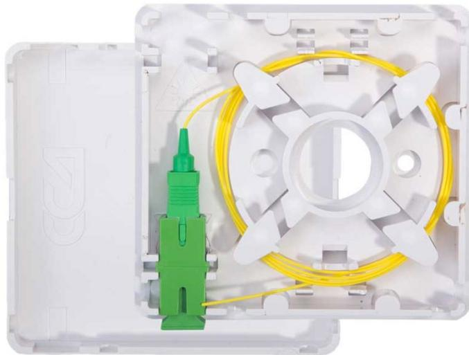
Предназначены для установки в офисе или квартире абонента. Конструкция предусматривает возможность выкладки запаса кабеля. Несмотря на малые габариты, розетки рассчитаны на размещение ОВ любого типа (G.652, G657). Оконцевание (монтаж) входящего ОВ возможно производить с помощью сварки, установки механического соединителя либо с использованием неполируемого оптического коннектора. Адаптер устанавливается в одно из посадочных мест на основании корпуса.
